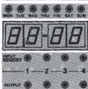
Figura 2. Los conmutadores de membrana extremadamente delgados posibilitan que el teclado y el panel frontal se combinen en un sólo elemento. Las cubiertas transparentes del display y de los diodos LED son también partes integrantes del panel frontal.
