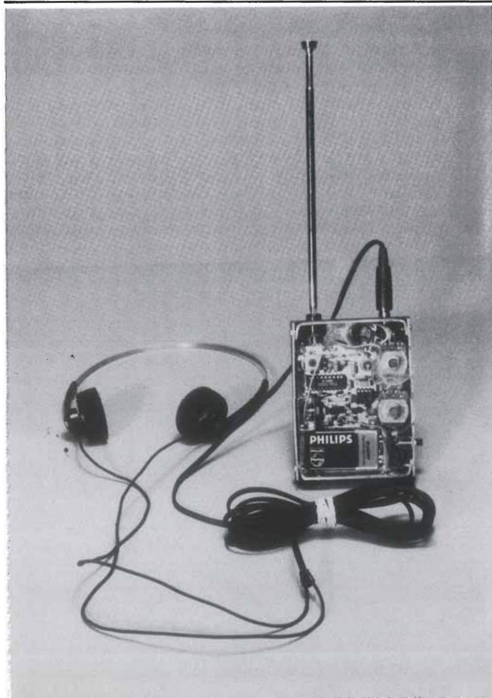
Figura 2. Esquema de nuestro receptor «personal FM». La adición de una red de sintonía a varicap y de un preamplificador de A.F. suplementario mejora sensiblemente la recepción.
